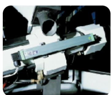
Tutti i movimenti sono gestiti dal display e controllati da potenziometri lineari.
