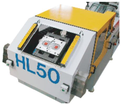
**CICLO SEMI-AUTOMATICO:** azionando la rotazione della testa, il portastampo (lato estrazione) gira in posizione verticale per un facile inserimento manuale di fasce cuoio o spine di metallo direttamente nello stampo.
