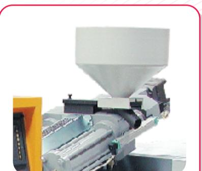
La nuova unità di iniezione assicura un'ottima plastificazione in vite del materiale plastico.
